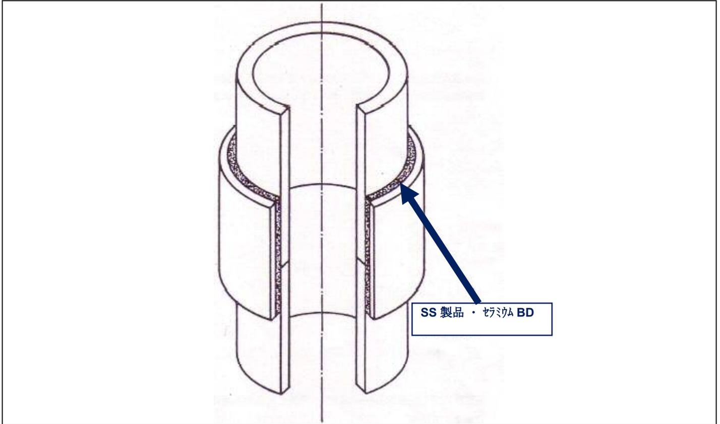
異種類の金属・合金製品等の接続を賢固に行う事ができます。
