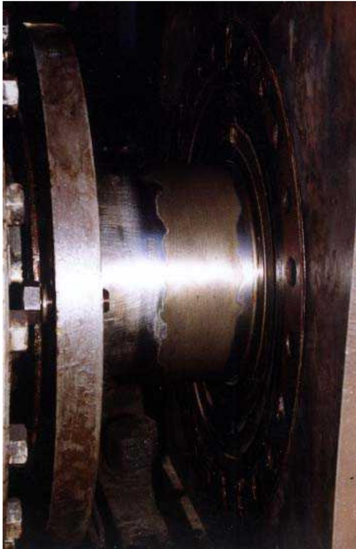
鉱石搬送用コンベヤベルトを動かすギアモーターのシャフトが擦り切れ、ポリマータルによって再生されました。モリタルをシャフトの傷ついた部分に塗り、部分養生後、人の手と機械で理想の面積に研磨紙で磨きました。設備の分解や廃棄交換を考えると問題解決にマルチタルを使用する大きな利点がありました。当然、この現代的修理法によって67時間の機械の停止を回避する事ができました。
