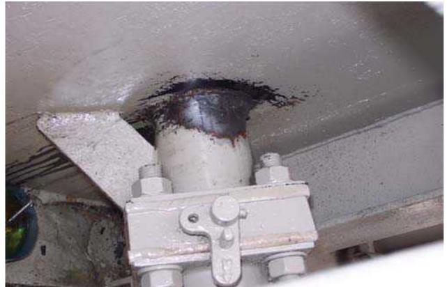
溶接の継ぎ目の微細な亀裂からオイルがにじみ出ていました。オイルの漏れは、通常の溶接による補修の試みが失敗した後、拡大していました。その後、はっきりとMM-メタルoL-スチールセラミック、硬化剤(赤)、補強重ね塗り用として硬化剤(黄)を使用した“直接MM接着法”を用いた補修が決定しました。
